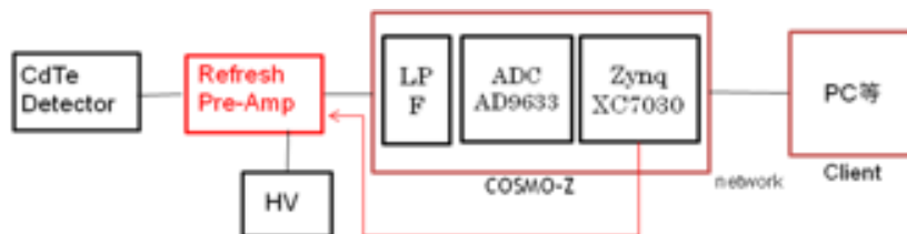
図 3.1.1-17 試作した検出器のブロック図
