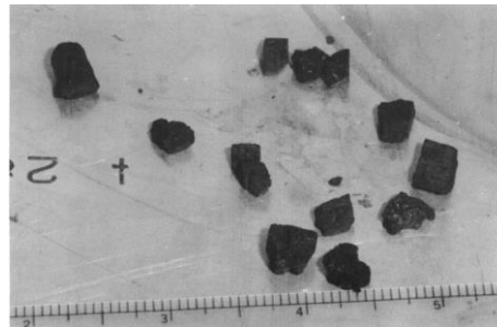
図 3.1.4-4 TMI-2 で最初に採取された燃料デブリ粒子サンプル
