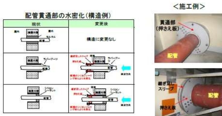
図 18 水密対策による浸水防止
