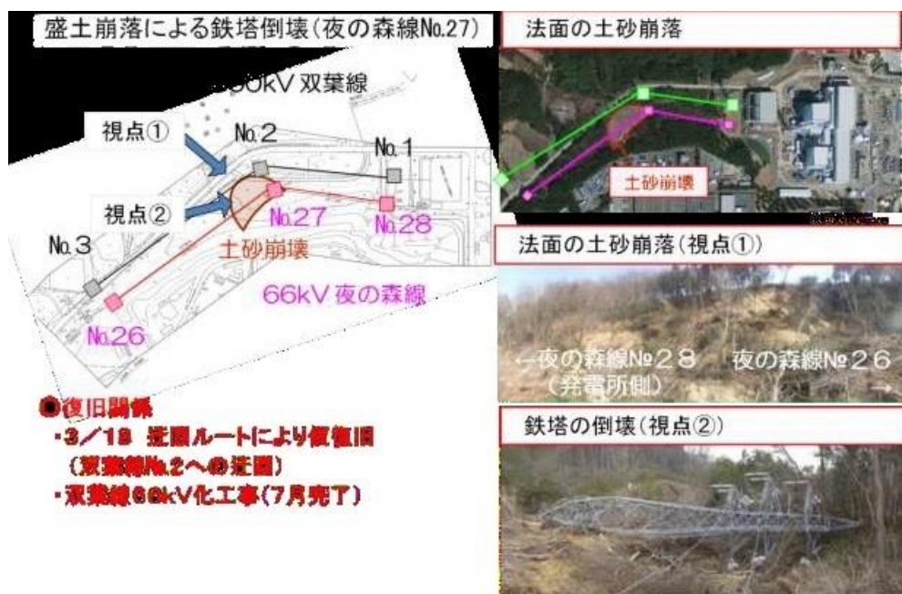
図1 盛土崩落による鉄塔崩壊 夜の森線
