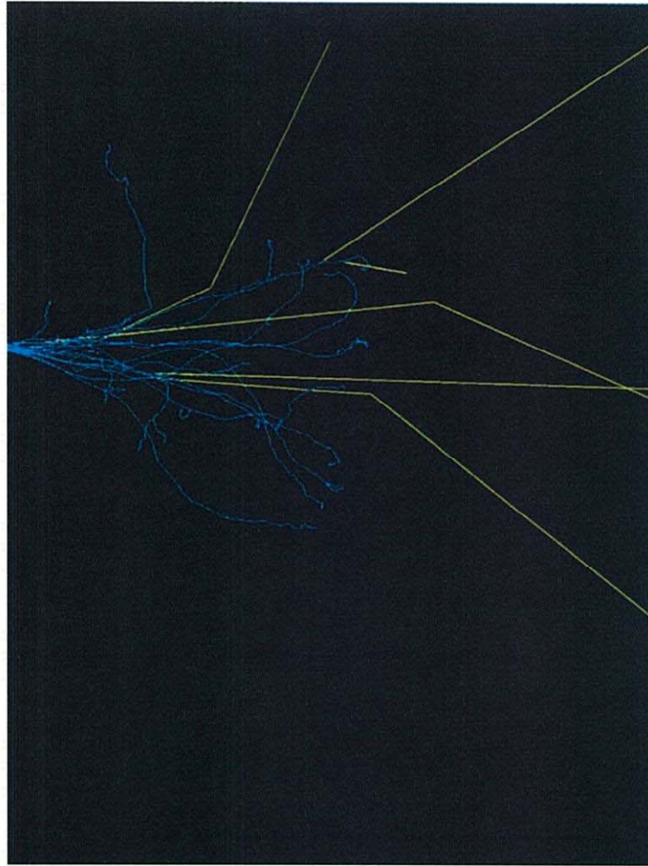
図 14 電子や陽電子、 \gamma 線の相互作用を追跡するEGS4モンテカルロコードによるシミュレーション
