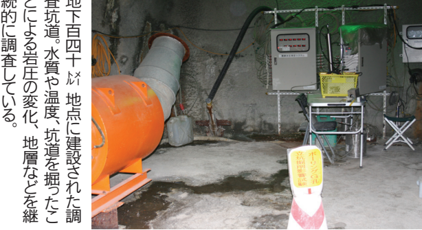
地下四百四十メートル地点に建設された調査坑道。水質や温度、坑道を掘ったことによる岩圧の変化、地層などを継続的に調査している。
