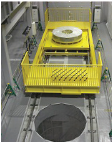
幌延深地層研究センターに設置された「地層処分実規模試験施設」内の「緩衝材設置試験装置」の内部の様子。
