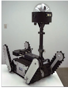
この新型ロボットは、千葉工業大学が独自に開発した災害用ロボット「櫻志號」(さくらいちご)のII号機をベースとし、同センター内での試験運用から得られた成果・知見をもとに改良を加え、日南により製造された「原発対応版」で、原子炉建屋内の移動に伴う幅七百mmの階段
